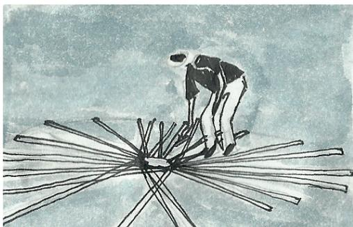
29 Poner La estructura extendida en el piso, así se podrán unir los dos extremos que faltan por sujetar para cerrar la estructura en su totalidad.
