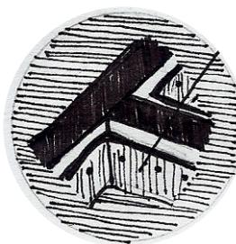
**C.** Poner plástico o aislante clavado con puntillas pequeñas o grapadora para evitar que la humedad del piso pase a la estructura.
